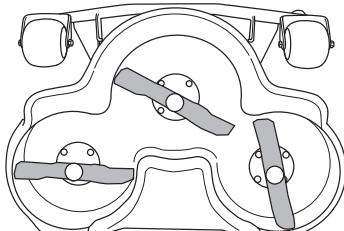
**ВНИМАНИЕ!** Разбалансировка одного или более ножа, вызванная повреждением или неправильной балансировкой после заточки, может привести к вибрациям в машине.
