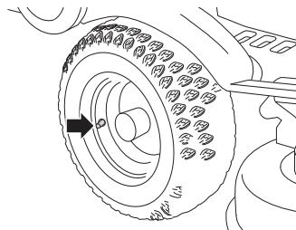
**ВНИМАНИЕ!** Неодинаковое давление в шинах приводит к тому, что стрижка травы будет неровной. Для того чтобы достичь наилучшей производительности, а также избежать повреждения машины, необходимо, чтобы давление в шинах было одинаковым.
