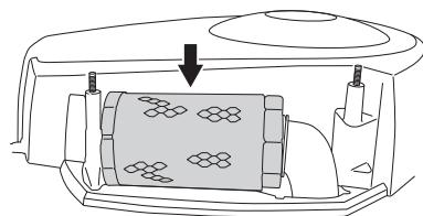
**ВНИМАНИЕ!** Никогда не включайте двигатель со снятым воздушным фильтром!
