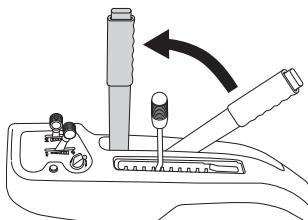
Если нажать на кнопку фиксации и перевести рычаг вперед, то рабочий узел начнет опускаться, и ножи автоматически начнут вращаться (положение стрижки).
