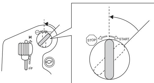
**ВАЖНО!** Не держите стартер в рабочем положении более 5 секунд. Если двигатель не заводится, подождите примерно 15 секунд перед попыткой повторного запуска.
