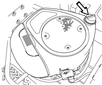
Вставьте затем опять щуп. Масломерный щуп должен быть полностью ввинчен
